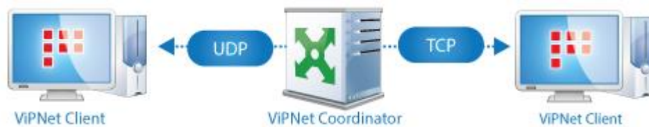
Рисунок 35. Сетевые узлы соединяются через межсетевой экран
