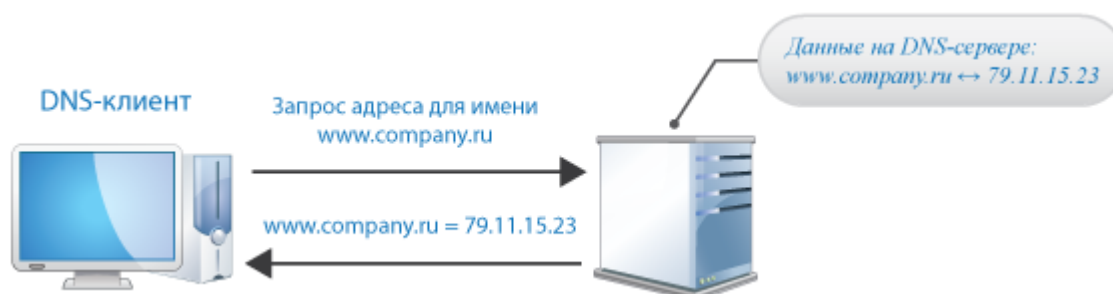
Рисунок 43. Общий принцип работы службы DNS
