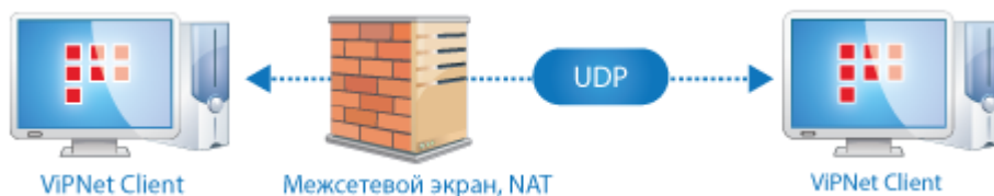
Рисунок 34. Сетевые узлы соединяются через межсетевой экран
